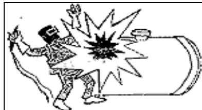
Explosion due à un dégazage incomplet
