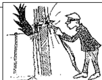
Inflammation au contact de conduites invisibles chauffées
