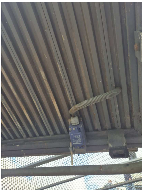
Fig. 9 — Boîte de dérivation pantographe non étanche
