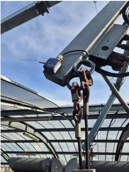
Fig. 5 — Contacts de surcharge oxydés
