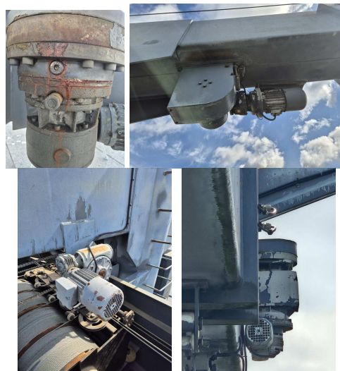
Fig. 12 — Moteurs grippés (levage, rotation, palonnier, contrepoids, treuil aux.)
