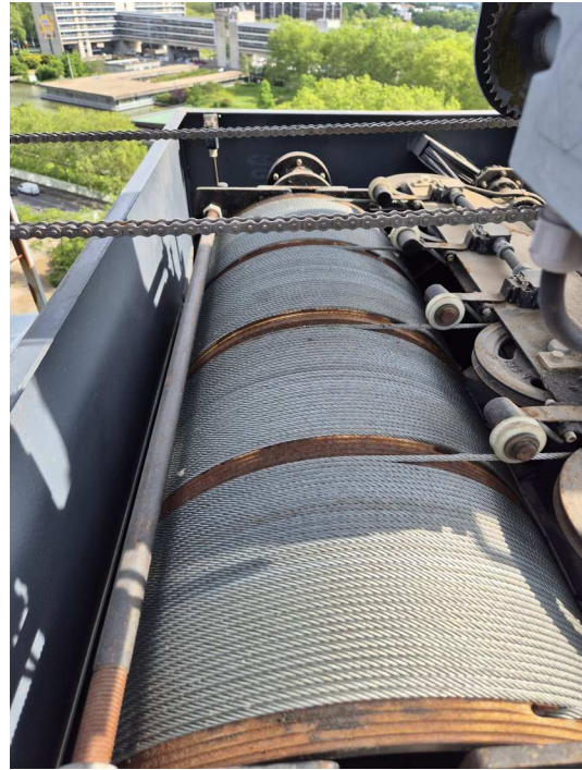
Fig. 22 — Tambour de levage oxydé
