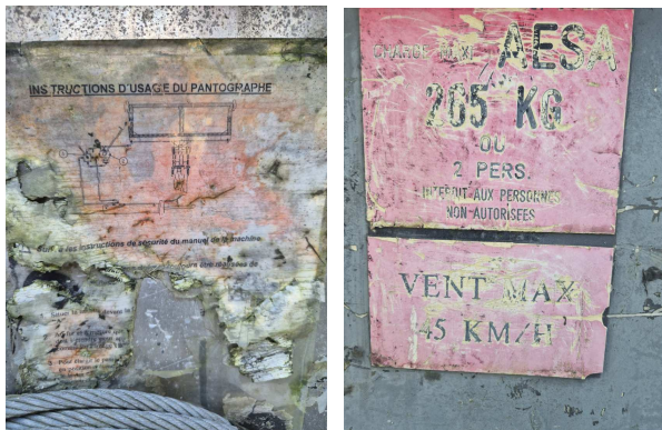
Fig. 11 — Consigne d'usage du pantographe et plaque CMU / vent illisibles
