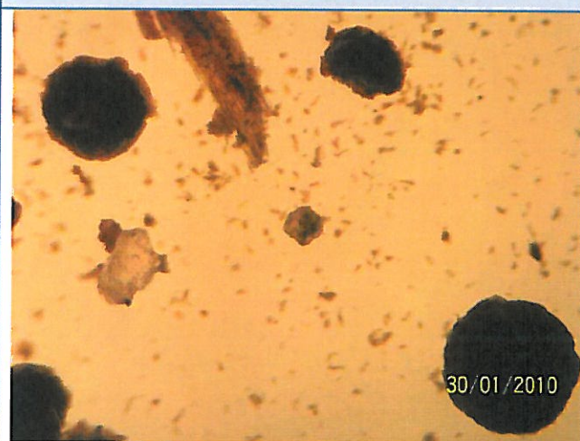
Ech. 1 – Aspect des vermoulures. (éclairage diascopique) (Grossissement x200)
