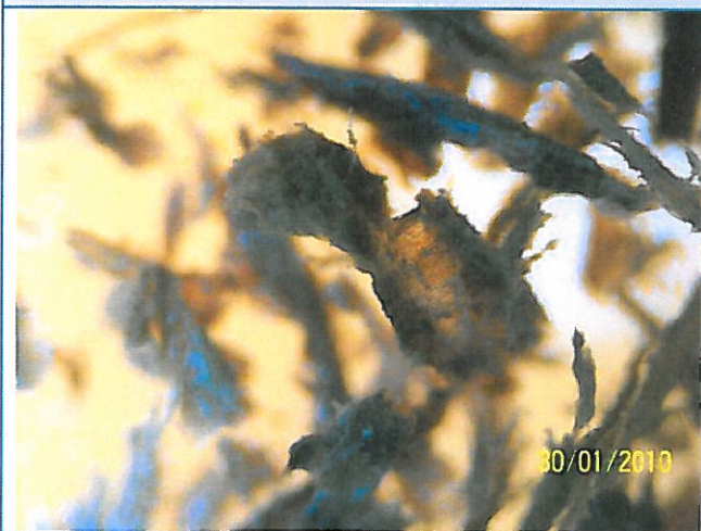
Ech. 1 - Aspect des vermoulures (éclairage épiscopique et diascopique) (Grossissement x180)
