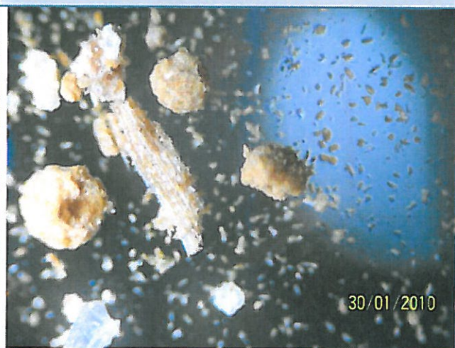
Ech. 1 - Aspect des vermoulures (éclairage épiscopique) (Grossissement x200)
