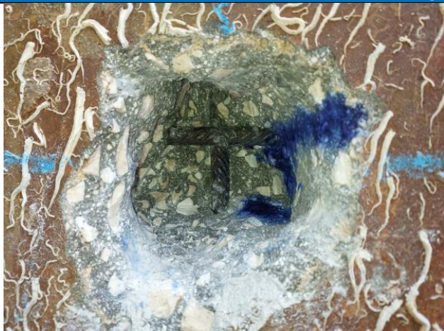
Photographie 13 : Sondage SD1 sur massif 1.1 face A, aciers sains et absence de carbonatation
