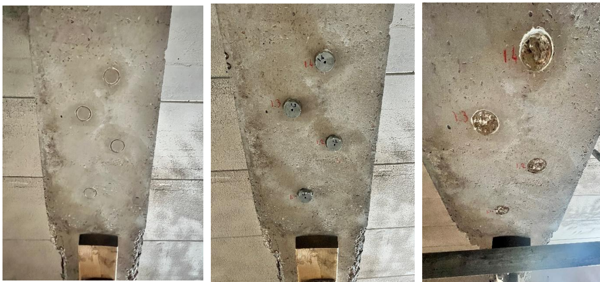
Fig. 14 : Illustration des différentes étapes de l'essai d'adhérence
