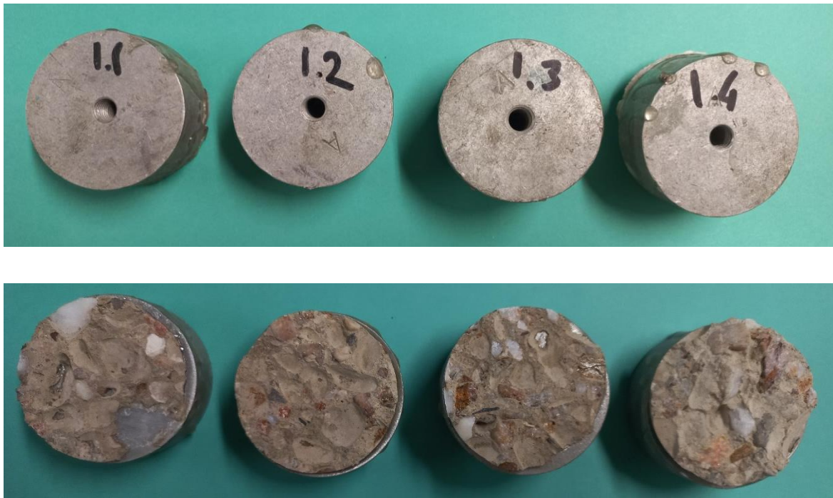
Fig. 15 : Illustration du mode de rupture des pastilles de la zone en sous face de la poutre P2
